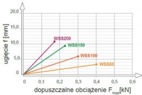
Mocowanie ścienne - dopuszczalne obciążenie w zależności od typu śruby rozporowej (typ kotwy)
