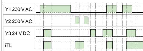
Jungimas per selektorinį jungiklį: 230 V AC ir 24 V DC valdymas (Y1=1 arba Y1=0)
