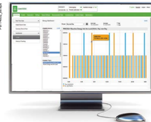
Elektros energijos prietaisų skydelis, kuriame palyginamos per laiką sukauptos energijos suvartojimo vertės (dalinis ekranas)
