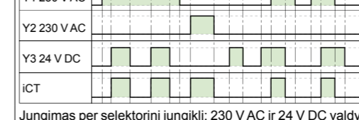
Jungimas per selektorinį jungiklį: 230 V AC ir 24 V DC valdymas (Y1=1 arba Y1=0)
