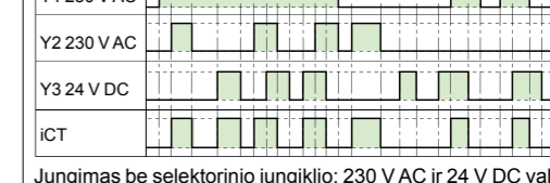
Jungimas be selektorinio jungiklio: 230 V AC ir 24 V DC valdymas
